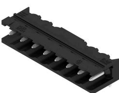
90° 각도의 내고온 개방형 수형 헤더 박스 또는 테이프 포장. 자동 조립에 최적화된 1.5 mm 용접 핀의 테이프 형태. 리플로우 및 웨이브 용접에 적합한 3.2 mm 솔더 핀. 핀 헤더는 라벨링을 위한 공간을 제공하며 코딩이 가능합니다. HC = 고전류
