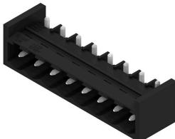
내열성, 직선, 개방형 끝단의 핀 헤더. 박스 또는 테이프 포장. 자동 조립에 최적화된 1.5 mm 용접 핀의 테이프 형태. 리플로우 및 웨이브 용접에 적합한 3.2 mm 솔더 핀. 핀 헤더는 라벨링을 위한 공간을 제공하며 코딩이 가능합니다. HC = 고전류
