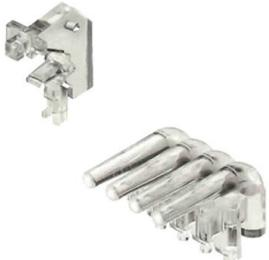
효율성: LED와 전면 판넬 사이 링크. Floodlight indicator를 사용하면 특별한 설계 없이도 스위칭 상태를 모니터링할 수 있습니다. 플라스틱 광섬유가 굽힘 주변의 표준 LED로부터 발생되는 빛을 커넥터 또는 전면 플레이트를 통해 안내합니다.
