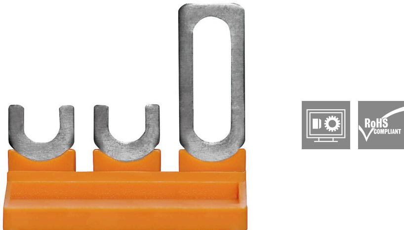
인접한 단자대에 전위를 분배 또는 증가시키는 것은 교차 연결을 통해 구현됩니다. 추가적인 결선 노력은 쉽게 피할 수 있습니다. 폴이 분리되더라도 단자대 블록의 접점 안정성은 여전히 보장됩니다. 당사의 포트폴리오는 모듈형 터미널 블록을 위한 플러그형 및 스크루형 점프바 시스템을 제공합니다.
