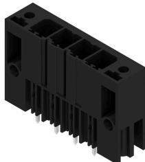
단층, 고성능 수형 헤더, 폴 손실이 없거나 공구 없이 빠른 고정을 위한 특허를 받은 플랜지를 사용한 병렬 장착용. 잘못된 결선을 방지하는 짹을 이루는 형태 덕분에 실현된 최대의 결선 및 작동 신뢰성과 특유의 다양한 코딩, 플랜지의 추가 조임. 3.5 mm 핀 길이는 납이 없는 웨이브 솔더링에 최적화되어 있습니다.
