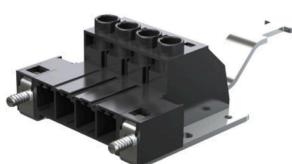
유지보수가 필요 없는 바이드뮬러의 스틸 클램프 결선을 지원하는 고성능 수형 헤더입니다. 공구 없이도 확실하고 빠르게 고정할 수 있도록 특허를 받은 다기능 플랜지를 사용하여 병렬로 장착합니다(볼 손실 없음). 잘못된 결선을 방지하는 짹을 이루는 형태로 올바르지 않은 결선을 방지하여 실현된 최대의 결선 및 작동 신뢰성과 특유의 다양한 코딩, 잘못된 배선 방지. 라벨링에 적합합니다.
