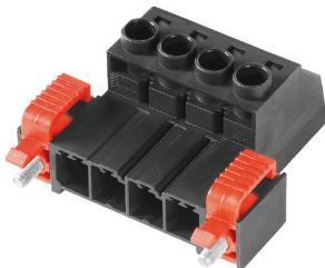
유지보수가 필요 없는 바이드뮬러의 스틸 클램프 결선을 지원하는 고성능 수형 헤더입니다. 공구 없이도 확실하고 빠르게 고정할 수 있도록 특허를 받은 다기능 플랜지를 사용하여 병렬로 장착합니다(볼 손실 없음). 잘못된 결선을 방지하는 짹을 이루는 형태로 올바르지 않은 결선을 방지하여 실현된 최대의 결선 및 작동 신뢰성과 특유의 다양한 코딩, 잘못된 배선 방지. 라벨링에 적합합니다.
