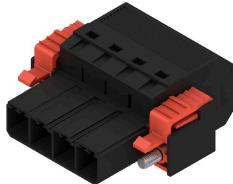
피치가 7.62인 6 mm<sup>2</sup>의 역방향 외부 플랜지와 함께 현장 배선을 위한 PUSH IN 결선 기술을 탑재한 역방향 수형 헤더 역방향 전압에 대해 접촉 보호 솔루션으로도 이상적입니다. UL1059 600 V 클래스 C 및 IEC 61800-5-1의 요구사항을 충족합니다.
