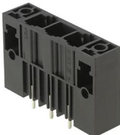
단층, 고전류 수형 헤더, 폴 손실이 없거나 공구 없이 빠른 잠금을 위한 특허 받은 플랜지를 사용한 병렬 장착용. 잘못된 결선을 방지하는 짹을 이루는 형태 덕분에 실현된 최대의 결선 및 작동 신뢰성과 특유의 다양한 코딩, 추가 조임 및 적분 가능한 위치 보조기능. 3.5 mm 핀 길이는 웨이브 솔더링에 최적화되어 있으며, 플러그인 방향은 솔더 핀에 대해 180°입니다.
