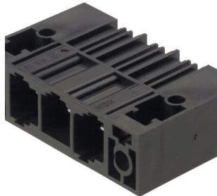
단층, 고전류 수형 헤더, 폴 손실이 없거나 공구 없이 빠른 잠금을 위한 특허 받은 플랜지를 사용한 병렬 장착용. 잘못된 결선을 방지하는 짹을 이루는 형태 덕분에 실현된 최대의 결선 및 작동 신뢰성과 특유의 다양한 코딩, 플랜지의 추가 조임. 3.5 mm 핀 길이는 웨이브 솔더링에 최적화되어 있으며, 플러그인 방향은 솔더 핀에 대해 90°입니다.
