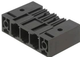
단층, 고성능 수형 헤더, 폴 손실이 없거나 공구 없이 빠른 고정을 위한 특허를 받은 플랜지를 사용한 병렬 장착용. 잘못된 결선을 방지하는 짹을 이루는 형태 덕분에 실현된 최대의 결선 및 작동 신뢰성과 특유의 다양한 코딩, 플랜지의 추가 조임. 3.5 mm 핀 길이는 웨이브 솔더링에 최적화되어 있으며, 플러그인 방향은 솔더 핀에 대해 270°입니다.
