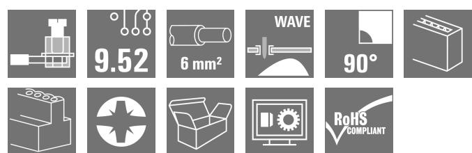
이 PCB 단자대는 9.52 mm 피치, 90° 컨덕터 아울렛 방향 설계의 안정적 클램핑 요크 결선으로 1000 V, 6 mm<sup>2</sup>의 컨덕터 단면적 및 32A에 대한 결선을 제공합니다.
