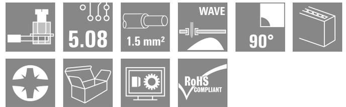
작고, 컴팩트하면서도 강력한 PCB 단자대로, 입증된 클램핑 요크 결선과 5.08 mm 피치를 채용했으며 용량은 17.5 A. 컨덕터 아울렛 방향 90°. 최대 1.5 mm<sup>2</sup>의 컨덕터 단면적에 적합.
