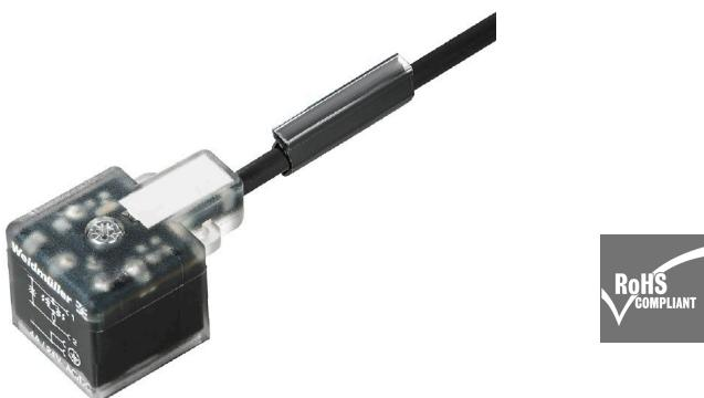
바이드뮬러에서는 M8/M12 플러그와 커넥터 없는 종단이 적용된 결선 라인으로 벨브 플러그를 제공할 수 있습니다. 벨브 플러그의 상태는 LED로 표시됩니다. 벨브 플러그에는 보호 회로가 있습니다. 바이드뮬러 제품군에는 벨브 플러그 유형 A, B 및 C 그리고 DIN과 산업 표준이 포함됩니다. 나사로 고정하면 보호 등급 IP 67이 총족됩니다. 아웃렛 방향도 중요한 요소이므로 바이드뮬러는 다양한 버전을 제공합니다.
