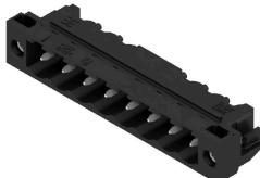
내열성 핀 헤더, 상자 또는 테이프로 포장됨. 자동 조립에 최적화된 1.5 mm 용접 핀의 테이프 형태. 리플로우 및 웨이브 용접에 적합한 3.2 mm 솔더 핀. 핀 헤더는 라벨링을 위한 공간을 제공하며 코딩이 가능합니다. HC = 고전류
