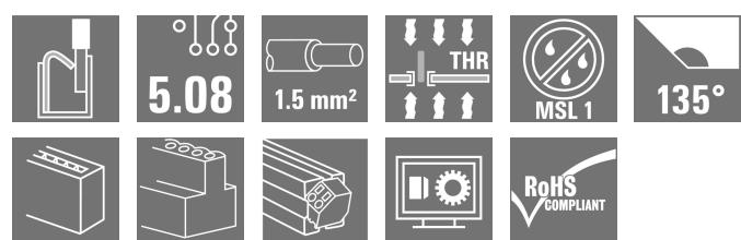
리플로우 용접(SMT)에서 완전 자동 조립을 위한 PCB 단자대. Push In 컨덕터 시스템 채용. 컨덕터가 삽입되고 슬라이더가 같은 방향으로 작동(TOP). 박스 또는 테이프 릴 포장. 핀 길이는 1.5 mm 또는 3.5 mm에서 최적화.
