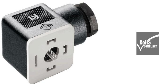
최근에는 각각 다양한 길이의 케이블이 종종 필요합니다. 이러한 요구를 충족할 수 있도록 바이드뮬러에서는 맞춤형 어셈블리를 위한 다양한 플러그 커넥터를 제공합니다. 맞춤형 밸브 플러그는 특수 목적의 머신 엔지니어링에 자주 사용됩니다. 이러한 플러그는 솔레노이드 밸브의 결선에 사용됩니다. 이 밸브 플러그는 모든 표준 설계 유형에서 사용할 수 있습니다. 제품 범위에는 Type A, B Industrial, B(DIN 규격), C Industrial 및 C(DIN 규격)가 포함됩니다. 이 밸브 플러그는 케이블 없는 3 폴 및 4 폴 버전으로 제공됩니다. 플랫 개스킷 실이 포함되어 스크류 고정 시 IP 65 보호를 보장합니다.
