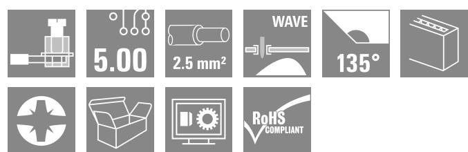
5.00 및 5.08 mm 피치의 입증된 클램프 결선이 있는 PCB 단자대. 컨덕터 아울렛 방향 90°, 135° 및 180°. 최대 2.5 mm<sup>2</sup>의 컨덕터 단면적에 적합.
