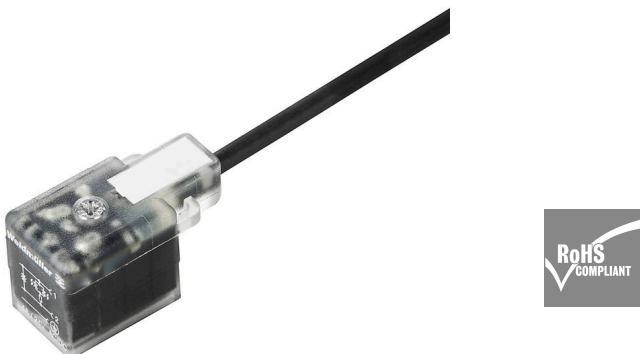
바이드뮬러에서는 M8/M12 플러그와 커넥터 없는 종단이 적용된 결선 라인으로 밸브 플러그를 제공할 수 있습니다. 밸브 플러그의 상태는 LED로 표시됩니다. 밸브 플러그에는 보호 회로가 있습니다. 바이드뮬러 제품군에는 밸브 플러그 유형 A, B 및 C 그리고 DIN과 산업 표준이 포함됩니다. 나사로 고정하면 보호 등급 IP 67이 총족됩니다. 아웃렛 방향도 중요한 요소이므로 바이드뮬러는 다양한 버전을 제공합니다.
