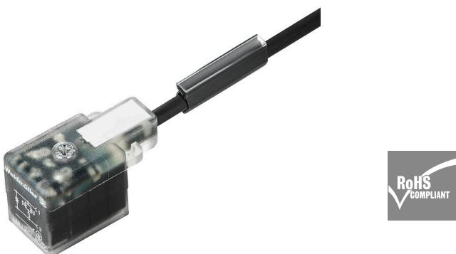
바이드뮬러에서는 M8/M12 플러그와 커넥터 없는 종단이 적용된 결선 라인으로 벨브 플러그를 제공할 수 있습니다. 벨브 플러그의 상태는 LED로 표시됩니다. 벨브 플러그에는 보호 회로가 있습니다. 바이드뮬러 제품군에는 벨브 플러그 유형 A, B 및 C 그리고 DIN과 산업 표준이 포함됩니다. 나사로 고정하면 보호 등급 IP 67이 총족됩니다. 아웃렛 방향도 중요한 요소이므로 바이드뮬러는 다양한 버전을 제공합니다.
