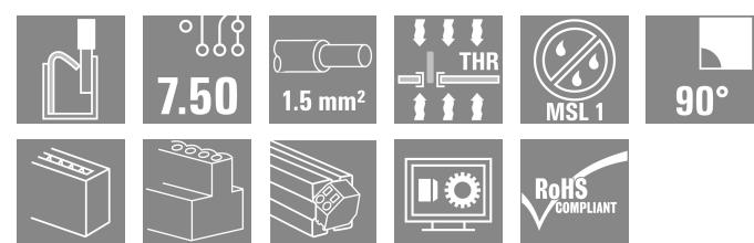
리플로우 용접(SMT)에서 완전 자동 조립을 위한 PCB 단자대. Push In 컨덕터 시스템 채용. 컨덕터가 삽입되고 슬라이더가 같은 방향으로 작동(TOP). 박스 또는 테이프 릴 포장. 핀 길이는 1.5 mm 또는 3.5 mm에서 최적화.
