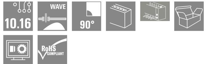
단층, 고전류 수형 헤더, 풀 손실이 없거나 공구 없이 빠른 잠금을 위한 특허 받은 플랜지를 사용한 병렬 장착용. 잘못된 결선을 방지하는 짝을 이루는 형태 덕분에 실현된 최대의 결선 및 작동 신뢰성과 특유의 다양한 코딩, 플랜지의 추가 조임. 3.5 mm 핀 길이는 웨이브 솔더링에 최적화되어 있으며, 플러그인 방향은 솔더 핀에 대해 90°입니다.
