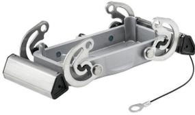
금형 주조한 특수 합금과 멀티 레이어 표면 실링 처리가 HDC 하우징을 완벽하게 보호합니다. 빈틈없이 설계된 인터록 시스템은 스테인리스 스틸로 제작되었습니다. 따라서 제품 수명이 길 뿐만 아니라 부식과 충격에 강합니다. 하우징 인터록 시스템은 통합 안전을 제공합니다. 특허를 받은 바이드물러의 고유한 스프링 시스템은 하우징 인터록에 안전한 그림감을 제공하고 인터록 시스템이 실수로 열리지 않도록 방지합니다. 레이저 마킹을 활용하면 쉽고 빠르게 마킹할 수 있습니다. 각 하우징 제품을 신속하게 지정하고 배치할 수 있도록 레이저 마킹을 통해 각 하우징을 영구적으로 라벨링합니다. 바이드물러 RockStar® IP 65 / NEMA 타입 4X 하우징 - IP 65 보호 등급의 산업용 하우징을 위한 1차적 선택.
