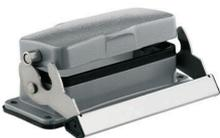
금형 주조한 특수 합금과 멀티 레이어 표면 실링 처리가 HDC 하우징을 완벽하게 보호합니다. 빈틈없이 설계된 인터록 시스템은 스테인리스 스틸로 제작되었습니다. 따라서 제품 수명이 길 뿐만 아니라 부식과 충격에 강합니다. 하우징 인터록 시스템은 통합 안전을 제공합니다. 특허를 받은 바이드물러의 고유한 스프링 시스템은 하우징 인터록에 안전한 그림감을 제공하고 인터록 시스템이 실수로 열리지 않도록 방지합니다. 레이저 마킹을 활용하면 쉽고 빠르게 마킹할 수 있습니다. 각 하우징 제품을 신속하게 지정하고 배치할 수 있도록 레이저 마킹을 통해 각 하우징을 영구적으로 라벨링합니다. 바이드물러 RockStar® IP 65 / NEMA 타입 4X 하우징 - IP 65 보호 등급의 산업용 하우징을 위한 1차적 선택.
