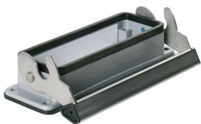
금형 주조한 특수 합금과 멀티 레이어 표면 실링 처리가 HDC 하우징을 완벽하게 보호합니다. 빈틈없이 설계된 인터록 시스템은 스테인리스 스틸로 제작되었습니다. 따라서 제품 수명이 길 뿐만 아니라 부식과 충격에 강합니다. 하우징 인터록 시스템은 통합 안전을 제공합니다. 특허를 받은 바이드뮬러의 고유한 스프링 시스템은 하우징 인터록에 안전한 그립감을 제공하고 인터록 시스템이 실수로 열리지 않도록 방지합니다. 레이저 마킹을 활용하면 쉽고 빠르게 마킹할 수 있습니다. 각 하우징 제품을 신속하게 지정하고 배치할 수 있도록 레이저 마킹을 통해 각 하우징을 영구적으로 라벨링합니다. 바이드뮬러 RockStar® IP 65 / NEMA 타입 4X 하우징 - IP 65 보호 등급의 산업용 하우징을 위한 1차적 선택.
