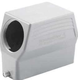
금형 주조한 특수 합금과 멀티 레이어 표면 실링 처리가 HDC 하우징을 완벽하게 보호합니다. 빈틈없이 설계된 인터록 시스템은 스테인리스 스틸로 제작되었습니다. 따라서 제품 수명이 길 뿐만 아니라 부식과 충격에 강합니다. 하우징 인터록 시스템은 통합 안전을 제공합니다. 특허를 받은 바이드뮬러의 고유한 스프링 시스템은 하우징 인터록에 안전한 그립감을 제공하고 인터록 시스템이 실수로 열리지 않도록 방지합니다. 레이저 마킹을 활용하면 쉽고 빠르게 마킹할 수 있습니다. 각 하우징 제품을 신속하게 지정하고 배치할 수 있도록 레이저 마킹을 통해 각 하우징을 영구적으로 라벨링합니다. 바이드뮬러 RockStar® IP 65 / NEMA 타입 4X 하우징 - IP 65 보호 등급의 산업용 하우징을 위한 1차적 선택.
