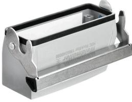
금형 주조한 특수 합금과 멀티 레이어 표면 실링 처리가 HDC 하우징을 완벽하게 보호합니다. 빈틈없이 설계된 인터록 시스템은 스테인리스 스틸로 제작되었습니다. 따라서 제품 수명이 길 뿐만 아니라 부식과 충격에 강합니다. 하우징 인터록 시스템은 통합 안전을 제공합니다. 특허를 받은 바이드물러의 고유한 스프링 시스템은 하우징 인터록에 안전한 그립감을 제공하고 인터록 시스템이 실수로 열리지 않도록 방지합니다. 레이저 마킹을 활용하면 쉽고 빠르게 마킹할 수 있습니다. 각 하우징 제품을 신속하게 지정하고 배치할 수 있도록 레이저 마킹을 통해 각 하우징을 영구적으로 라벨링합니다. 바이드물러 RockStar® IP 65 / NEMA 타입 4X 하우징 - IP 65 보호 등급의 산업용 하우징을 위한 1차적 선택.
