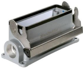
금형 주조한 특수 합금과 멀티 레이어 표면 실링 처리가 HDC 하우징을 완벽하게 보호합니다. 빈틈없이 설계된 인터록 시스템은 스테인리스 스틸로 제작되었습니다. 따라서 제품 수명이 길 뿐만 아니라 부식과 충격에 강합니다. 하우징 인터록 시스템은 통합 안전을 제공합니다. 특허를 받은 바이드물러의 고유한 스프링 시스템은 하우징 인터록에 안전한 그림감을 제공하고 인터록 시스템이 실수로 열리지 않도록 방지합니다. 레이저 마킹을 활용하면 쉽고 빠르게 마킹할 수 있습니다. 각 하우징 제품을 신속하게 지정하고 배치할 수 있도록 레이저 마킹을 통해 각 하우징을 영구적으로 라벨링합니다. 바이드물러 RockStar® IP 65 / NEMA 타입 4X 하우징 - IP 65 보호 등급의 산업용 하우징을 위한 1차적 선택.
