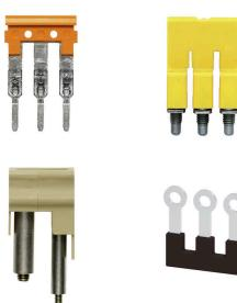
인접한 단자대에 전위를 분배 또는 증가시키는 것은 교차 연결을 통해 구현됩니다. 추가적인 결선 노력을 쉽게 피할 수 있습니다. 폴이 분리되더라도 단자대 블록의 접점 안정성은 여전히 보장됩니다. 당사의 포트폴리오는 모듈형 터미널 블록을 위한 플러그형 및 스크루형 점프바 시스템을 제공합니다.
