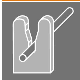
최근에는 각각 다양한 길이의 케이블이 종종 필요합니다. 이러한 요구를 충족할 수 있도록 바이드뮬러에서는 맞춤형 어셈블리를 위한 다양한 플러그 커넥터를 제공합니다. M8, M12, M16 및 7/8" 결선(탁월한 견고성으로 머신 엔지니어링 등에 이상적임)용 맞춤형 어셈블리를 위한 수형 플러그와 암형 소켓. M12 플러그 커넥터를 사용하는 경우 5가지의 결선형 중에서 선택할 수 있습니다. IDC 기술을 사용하면 전선을 압착하거나 탈피하지 않고도 단자대 접점에 직접 삽입할 수 있기 때문에 간단하고 신속하게 조립할 수 있습니다. 또한 기능적 보안도 탁월합니다.
