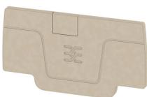
종판과 엔드 플레이트는 단자대의 필수 부속품입니다. 종판은 서로 다른 전위와 기능 그룹을 광학적으로 및 전기적으로 분리하여 안전성을 높이고 배전반 내부의 명확한 구조를 보장합니다. 엔드 플레이트는 측면의 단자대 열을 마감하고, 전류가 흐르는 부품과의 접촉을 방지하며, 깔끔하고 안정적인 마감을 보장합니다. 두 부품 모두 각각의 바이드뮐러 단자대 시리즈에 정확히 대응되어 안전하고 규정을 준수하며 전문적인 배선에 기여합니다.
