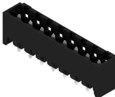
내열성 핀 헤더, 상자 또는 테이프로 포장됨. 자동 조립에 최적화된 1.5 mm 용접 핀의 테이프 형태. 리플로우 및 웨이브 용접에 적합한 3.2 mm 솔더 핀. 핀 헤더는 라벨링을 위한 공간을 제공하며 코딩이 가능합니다. HC = 고전류
