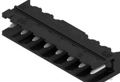
90° 각도의 내고온 개방형 수형 헤더 박스 또는 테이프 포장. 자동 조립에 최적화된 1.5 mm 용접 핀의 테이프 형태. 리플로우 및 웨이브 용접에 적합한 3.2 mm 슬더 핀. 핀 헤더는 라벨링을 위한 공간을 제공하며 코딩이 가능합니다. HC = 고전류
