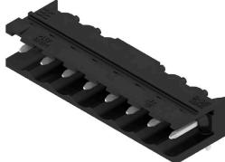
90° 각도의 내고운 개방형 수형 헤더 박스 또는 테이프 포장. 자동 조립에 최적화된 1.5 mm 용접 핀의 테이프 형태. 리플로우 및 웨이브 용접에 적합한 3.2 mm 솔더 핀. 핀 헤더는 라벨링을 위한 공간을 제공하며 코딩이 가능합니다. HC = 고전류
