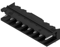
90° 각도의 내고운 개방형 수형 헤더 박스 또는 테이프 포장. 자동 조립에 최적화된 1.5 mm 용접 핀의 테이프 형태. 리플로우 및 웨이브 용접에 적합한 3.2 mm 슬더 핀. 핀 헤더는 라벨링을 위한 공간을 제공하며 코딩이 가능합니다. HC = 고전류
