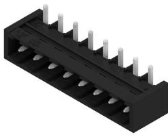
내열성, 직선, 개방형 끝단의 핀 헤더. 박스 또는 테이프 포장. 자동 조립에 최적화된 1.5 mm 용접 핀의 테이프 형태. 리플로우 및 웨이브 용접에 적합한 3.2 mm 솔더 핀. 핀 헤더는 라벨링을 위한 공간을 제공하며 코딩이 가능합니다. HC = 고전류
