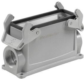
금형 주조한 특수 합금과 멀티 레이어 표면 실링 처리가 HDC 하우징을 완벽하게 보호합니다. 빈틈없이 설계된 인터록 시스템은 스테인리스 스틸로 제작되었습니다. 따라서 제품 수명이 길 뿐만 아니라 부식과 충격에 강합니다. 하우징 인터록 시스템은 통합 안전을 제공합니다. 특허를 받은 바이드물러의 고유한 스프링 시스템은 하우징 인터록에 안전한 그림감을 제공하고 인터록 시스템이 실수로 열리지 않도록 방지합니다. 레이저 마킹을 활용하면 쉽고 빠르게 마킹할 수 있습니다. 각 하우징 제품을 신속하게 지정하고 배치할 수 있도록 레이저 마킹을 통해 각 하우징을 영구적으로 라벨링합니다. 바이드물러 RockStar® IP 65 / NEMA 타입 4X 하우징 - IP 65 보호 등급의 산업용 하우징을 위한 1차적 선택.
