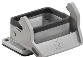
금형 주조한 특수 합금과 멀티 레이어 표면 실링 처리가 HDC 하우징을 완벽하게 보호합니다. 빈틈없이 설계된 인터록 시스템은 스테인리스 스틸로 제작되었습니다. 따라서 제품 수명이 길 뿐만 아니라 부식과 충격에 강합니다. 하우징 인터록 시스템은 통합 안전을 제공합니다. 특허를 받은 바이드뮬러의 고유한 스프링 시스템은 하우징 인터록에 안전한 그립감을 제공하고 인터록 시스템이 실수로 열리지 않도록 방지합니다. 레이저 마킹을 활용하면 쉽고 빠르게 마킹할 수 있습니다. 각 하우징 제품을 신속하게 지정하고 배치할 수 있도록 레이저 마킹을 통해 각 하우징을 영구적으로 라벨링합니다. 바이드뮬러 RockStar® IP 65 / NEMA 타입 4X 하우징 - IP 65 보호 등급의 산업용 하우징을 위한 1차적 선택.
