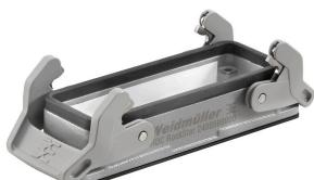
금형 주조한 특수 합금과 멀티 레이어 표면 실링 처리가 HDC 하우징을 완벽하게 보호합니다. 빈틈없이 설계된 인터록 시스템은 스테인리스 스틸로 제작되었습니다. 따라서 제품 수명이 길 뿐만 아니라 부식과 충격에 강합니다. 하우징 인터록 시스템은 통합 안전을 제공합니다. 특허를 받은 바이드뮬러의 고유한 스프링 시스템은 하우징 인터록에 안전한 그립감을 제공하고 인터록 시스템이 실수로 열리지 않도록 방지합니다. 레이저 마킹을 활용하면 쉽고 빠르게 마킹할 수 있습니다. 각 하우징 제품을 신속하게 지정하고 배치할 수 있도록 레이저 마킹을 통해 각 하우징을 영구적으로 라벨링합니다. 바이드뮬러 RockStar® IP 65 / NEMA 타입 4X 하우징 - IP 65 보호 등급의 산업용 하우징을 위한 1차적 선택.
