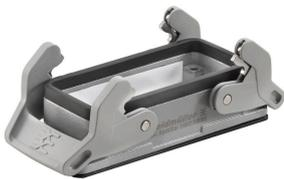
금형 주조한 특수 합금과 멀티 레이어 표면 실링 처리가 HDC 하우징을 완벽하게 보호합니다. 빈틈없이 설계된 인터록 시스템은 스테인리스 스틸로 제작되었습니다. 따라서 제품 수명이 길 뿐만 아니라 부식과 충격에 강합니다. 하우징 인터록 시스템은 통합 안전을 제공합니다. 특허를 받은 바이드물러의 고유한 스프링 시스템은 하우징 인터록에 안전한 그립감을 제공하고 인터록 시스템이 실수로 열리지 않도록 방지합니다. 레이저 마킹을 활용하면 쉽고 빠르게 마킹할 수 있습니다. 각 하우징 제품을 신속하게 지정하고 배치할 수 있도록 레이저 마킹을 통해 각 하우징을 영구적으로 라벨링합니다. 바이드물러 RockStar® IP 65 / NEMA 타입 4X 하우징 - IP 65 보호 등급의 산업용 하우징을 위한 1차적 선택.
