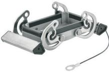
금형 주조한 특수 합금과 멀티 레이어 표면 실링 처리가 HDC 하우징을 완벽하게 보호합니다. 빈틈없이 설계된 인터록 시스템은 스테인리스 스틸로 제작되었습니다. 따라서 제품 수명이 길 뿐만 아니라 부식과 충격에 강합니다. 하우징 인터록 시스템은 통합 안전을 제공합니다. 특허를 받은 바이드몰러의 고유한 스프링 시스템은 하우징 인터록에 안전한 그림감을 제공하고 인터록 시스템이 실수로 열리지 않도록 방지합니다. 레이저 마킹을 활용하면 쉽고 빠르게 마킹할 수 있습니다. 각 하우징 제품을 신속하게 지정하고 배치할 수 있도록 레이저 마킹을 통해 각 하우징을 영구적으로 라벨링합니다. 바이드몰러 RockStar® IP 65 / NEMA 타입 4X 하우징 - IP 65 보호 등급의 산업용 하우징을 위한 1차적 선택.
