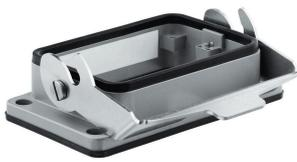
금형 주조한 특수 합금과 멀티 레이어 표면 실링 처리가 HDC 하우징을 완벽하게 보호합니다. 빈틈없이 설계된 인터록 시스템은 스테인리스 스틸로 제작되었습니다. 따라서 제품 수명이 길 뿐만 아니라 부식과 충격에 강합니다. 하우징 인터록 시스템은 통합 안전을 제공합니다. 특허를 받은 바이드물러의 고유한 스프링 시스템은 하우징 인터록에 안전한 그림감을 제공하고 인터록 시스템이 실수로 열리지 않도록 방지합니다. 레이저 마킹을 활용하면 쉽고 빠르게 마킹할 수 있습니다. 각 하우징 제품을 신속하게 지정하고 배치할 수 있도록 레이저 마킹을 통해 각 하우징을 영구적으로 라벨링합니다. 바이드물러 RockStar® IP 65 / NEMA 타입 4X 하우징 - IP 65 보호 등급의 산업용 하우징을 위한 1차적 선택.
