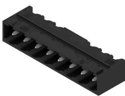
내열성 핀 헤더, 상자 또는 테이프로 포장됨. 자동 조립에 최적화된 1.5 mm 용접 핀의 테이프 형태. 리플로우 및 웨이브 용접에 적합한 3.2 mm 솔더 핀. 핀 헤더는 라벨링을 위한 공간을 제공하며 코딩이 가능합니다. HC = 고전류
