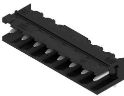
90° 각도의 내고온 개방형 수형 헤더 박스 또는 테이프 포장. 자동 조립에 최적화된 1.5 mm 용접 핀의 테이프 형태. 리플로우 및 웨이브 용접에 적합한 3.2 mm 슬더 핀. 핀 헤더는 라벨링을 위한 공간을 제공하며 코딩이 가능합니다. HC = 고전류
