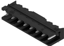
90° 각도의 내고온 개방형 수형 헤더 박스 또는 테이프 포장. 자동 조립에 최적화된 1.5 mm 용접 핀의 테이프 형태. 리플로우 및 웨이브 용접에 적합한 3.2 mm 슬더 핀. 핀 헤더는 라벨링을 위한 공간을 제공하며 코딩이 가능합니다. HC = 고전류
