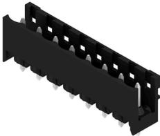
내열성, 직선, 개방형 끝단의 핀 헤더. 박스 또는 테이프 포장. 자동 조립에 최적화된 1.5 mm 용접 핀의 테이프 형태. 리플로우 및 웨이브 용접에 적합한 3.2 mm 슬더 핀. 핀 헤더는 라벨링을 위한 공간을 제공하며 코딩이 가능합니다. HC = 고전류
