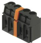
최대 전압은 최소 거리를 기준으로 합니다. 중간 판은 서로 다른 전위 사이의 연면 거리 및 에어 갭을 증가시켜 더 높은 정격 전압 또는 명확한 분리(예: 주전원과 저전압 간 또는 서로 다른 보호 구역 간)를 가능하게 합니다. 도브테일을 사용하면 쉬운 설치가 가능하고 안전한 피팅이 보장됩니다. 기타 특성:
