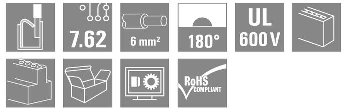
7.62 피치에서 6 mm<sup>2</sup>의 필드 배선을 위한 조절식 액추에이터(푸셔)를 탑재한 PUSH IN 결선형 180° 암형 플러그 UL1059 600 V 클래스 C 및 IEC 61800-5-1의 요구사항을 충족합니다. 전력 출력용 터치세이프 솔루션으로 이상적. 스크류 고정도 가능한 자가 잠금식 중간 플랜지는 기존의 솔루션에 비해 차지하는 공간을 1 피치 너비만큼 절약해 줍니다. 제품종류: 플랜지 없음, 외부 플랜지, 스냅온 메커니즘을 탑재한 중간 플랜지, 선택사양인 추가 스크류 장착.
