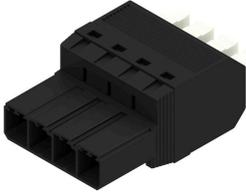
7.62 피치에서 6 mm<sup>2</sup>의 필드 배선을 위한 조절식 액추에이터(푸셔)를 탑재한 PUSH IN 결선형 180° 역방향 핀 헤더 역방향 전압에 대해 접촉 보호 솔루션으로도 이상적입니다. UL1059 600 V 클래스 C 및 IEC 61800-5-1의 요구사항을 충족합니다. 제품종류: 플랜지 없음, 외부 플랜지, 스냅온 메커니즘을 탑재한 중간 플랜지, 선택사양인 추가 스크류 장착.
