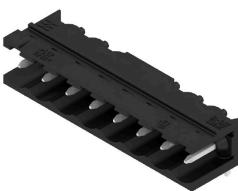
90° 각도의 내고온 개방형 수형 헤더 박스 또는 테이프 포장. 자동 조립에 최적화된 1.5 mm 용접 핀의 테이프 형태. 리플로우 및 웨이브 용접에 적합한 3.2 mm 솔더 핀. 핀 헤더는 라벨링을 위한 공간을 제공하며 코딩이 가능합니다. HC = 고전류
