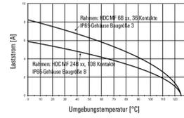
HDC-MHD 36-Module im IP65-Gehäuse,
