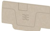
종판과 엔드 플레이트는 단자대의 필수 부속품입니다. 종판은 서로 다른 전위와 기능 그룹을 광학적으로 및 전기적으로 분리하여 안전성을 높이고 배전반 내부의 명확한 구조를 보장합니다. 엔드 플레이트는 측면의 단자대 열을 마감하고, 전류가 흐르는 부품과의 접촉을 방지하며, 깔끔하고 안정적인 마감을 보장합니다. 두 부품 모두 각각의 바이드뮐러 단자대 시리즈에 정확히 대응되어 안전하고 규정을 준수하며 전문적인 배선에 기여합니다.
