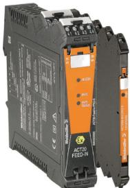
공급 전원의 공급과 분배를 분리하기 위한 전원 공급 어댑터: ACT20 시리즈/MICROSERIES 신호 컨버터용. 폭 22.5/6.1 mm의 전원 공급 모듈이 아날로그 신호 컨버터 주위에 직접 장착됩니다. 그런 다음 선택적으로 24 VDC 공급 전원이 CH20M(ACT20 시리즈) 레일 버스를 통해 브리지되거나 플러그형 ZOV 4N(MICROSERIES) 점프바를 사용하여 브리지됩니다.
