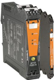
공급 전원의 공급과 분배를 분리하기 위한 전원 공급 어댑터: ACT20 시리즈/MICROSERIES 신호 컨버터용. 폭 22.5/6.1 mm의 전원 공급 모듈이 아날로그 신호 컨버터 주위에 직접 장착됩니다. 그런 다음 선택적으로 24 VDC 공급 전원이 CH20M(ACT20 시리즈) 레일 버스를 통해 브리지되거나 플러그형 ZQV 4N(MICROSERIES) 점프바를 사용하여 브리지됩니다.
